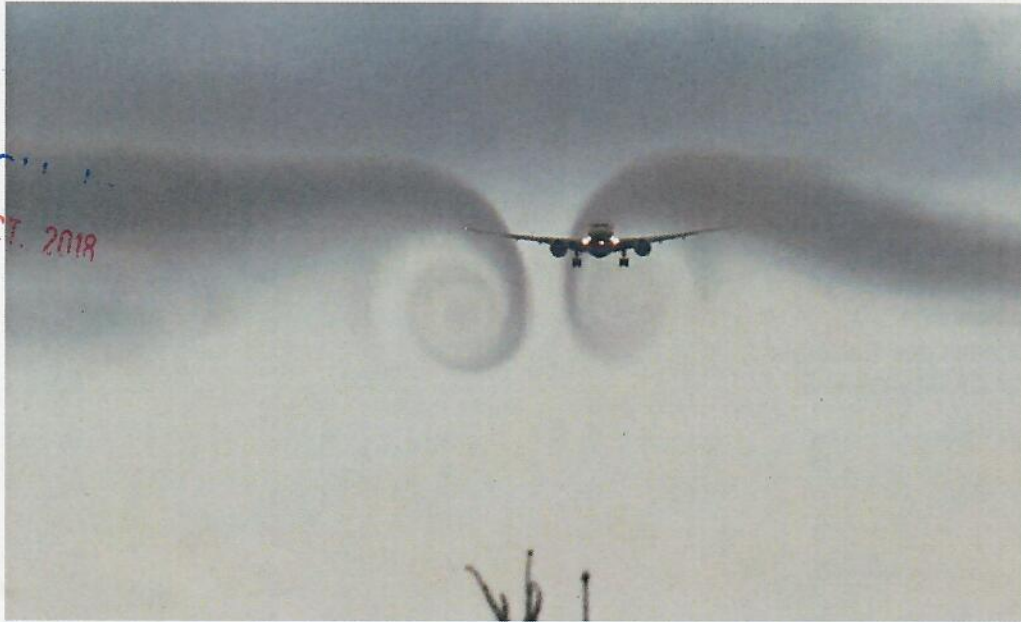
Turbulences de sillage derrière un Boeing 777-300ER à l'atterrissage à l'aéroport de Zurich (photo : srf Meteo)
